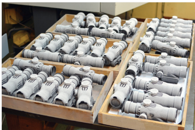
Celowniki podczas badań mechaniczno-klimatycznych, wykonywanych pod nadzorem klienta
