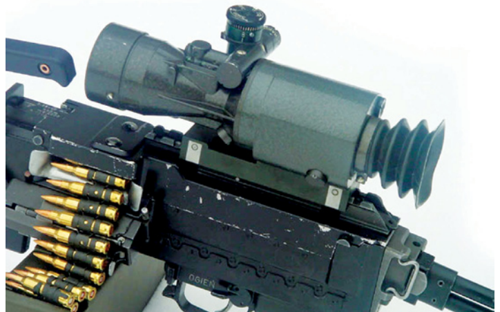
Zmodyfikowany celownik noktowizyjny NSP-3M
