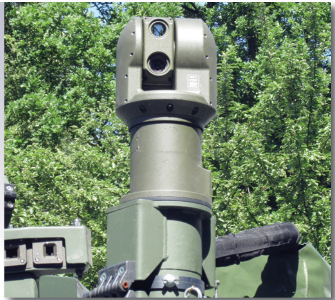
Kamera Obserwacji Termalnej KOT-I na Rosomaku WRT
