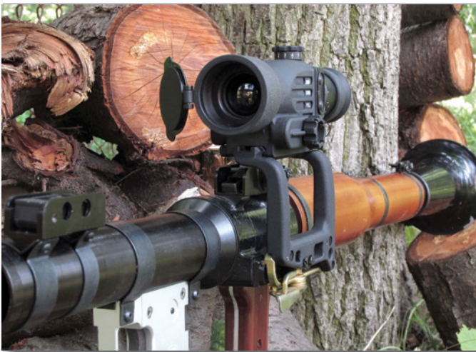
Celownik UTC-IS zamontowany na RPG-7. Urządzenie jest również przystosowane do współdziałania z różnymi typami broni strzeleckiej
