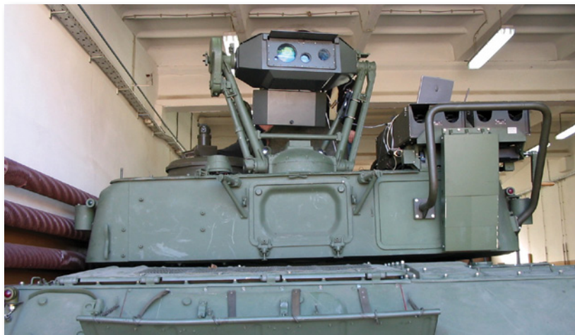
Łączący w sobie elementy dzienne i termowizyjne celownik ACRAB
