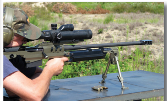
Łączący w sobie elementy dzienne i termowizyjne celownik ACRAB
